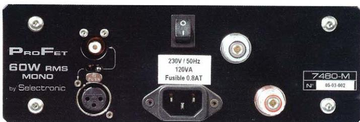
Ci-dessus, le dos de l'appareil où l'on remarque ses deux entrées asymétrique et symétrique commutables à l'aide d'un petit inverseur situé entre les deux prises.
