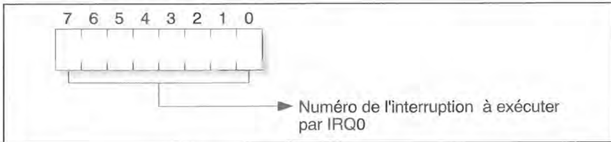
Structure de ICW2 pour initialiser le PIC
