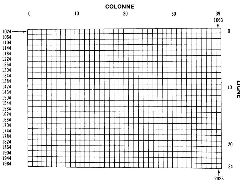
La mémoire de l'écran du COMMODORE 64 commence normalement sur l'emplacement de la mémoire 1024 et s'achève sur l'emplacement 2023. L'emplacement 1024 est le coin supérieur gauche de l'écran. L'emplacement 1025 est la position du caractère suivant à droite du précédent, etc. le long de la ligne. L'emplacement 1063 est la position la plus à droite de la première ligne. L'emplacement suivant le dernier caractère sur une ligne est le premier caractère de la ligne immédiatement dessous.
