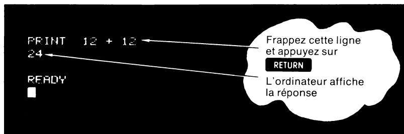
Ce que vous avez découvert est que le COMMODORE 64 est un calculateur dans sa forme de base. Le résultat «24» a été calculé et affiché automatiquement. En fait, vous pouvez également réaliser des soustractions, multiplications, divisions, élévarions à une puissance et des fonctions mathématiques avancées, telles que le calcul de racines carrées, etc. Vous n'êtes pas limité à un simple calcul sur une ligne, mais vous en saurez plus ultérieurement.
