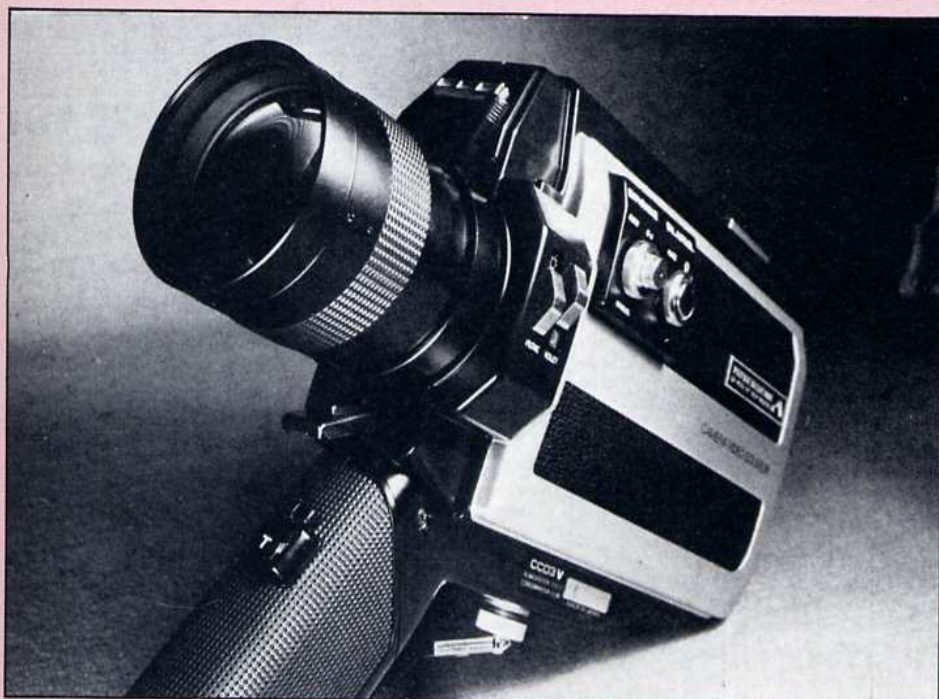
Aspect typique d'une caméra vidéo couleur « grand public » équipée d'un tube Vidicon à réseau de bandes colorées.
