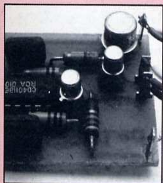
Insertion des composants, après pliage, sur le circuit imprimé.
