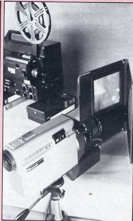
Transfert sur vidéo-cassette d'un film cinéma au moyen d'un « coude optique ».
