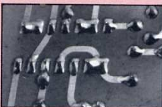
Opération de soudure d'un composant sur le circuit imprimé.
