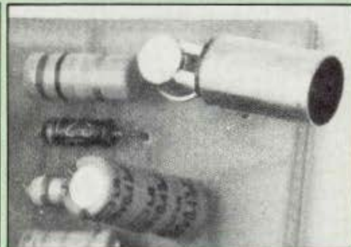
Les diodes led sont baguées avec un morceau de gaine plus ou moins long selon la directivité désirée.
