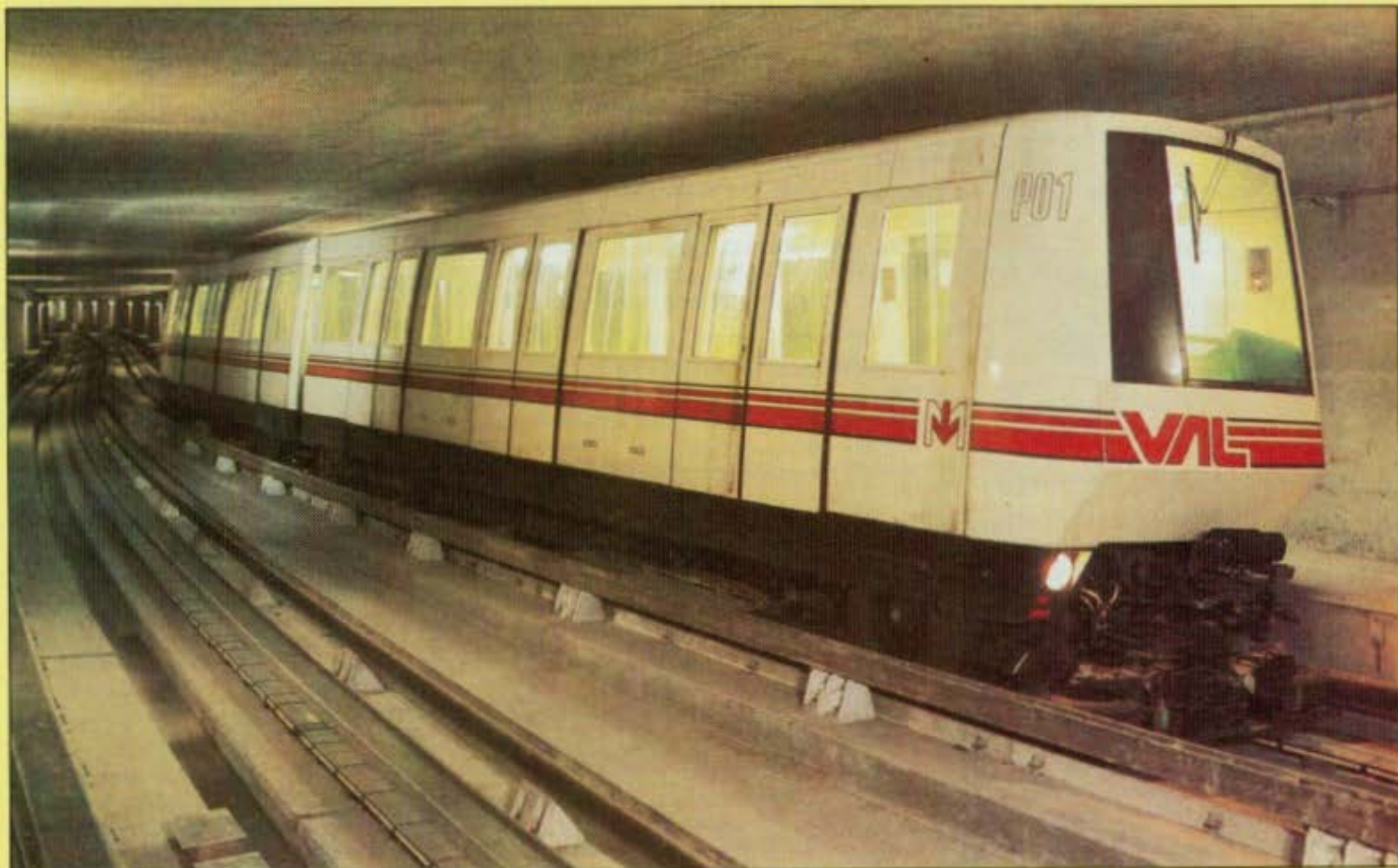
Aspect extérieur d'une rame VAL. On ne distingue pas de poste de conduite, mais l'automatisme d'attelage apparaît nettement.
