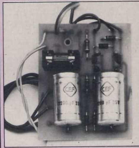
Module alimentation symétrique \pm 15 volts.
