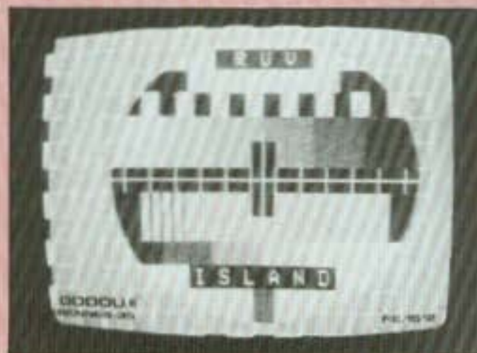
Islande RUV (1982). Mire électronique couleur PAL, type Philips PM 5544. Captée à Rennes. Canal E4. Emetteur : SKALAFEL. Puissance : 300 kW PAR.
