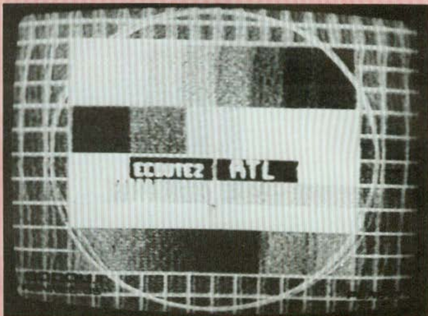
Luxembourg - RTL (1980). Capté à Rennes en UHF, canal 21. Mire électronique couleur Secam, type FUBK. Emetteur Dudelange. Puissance 1 000 KW PAR.
