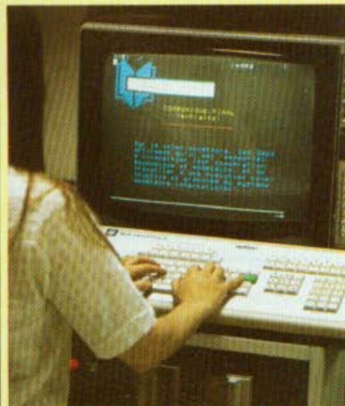
Première étape de la réalisation d'un magazine Antiope : la composition des pages de télétexte, par l'éditeur, précédant leur envoi — sous forme codée — vers les émetteurs de télévision.
