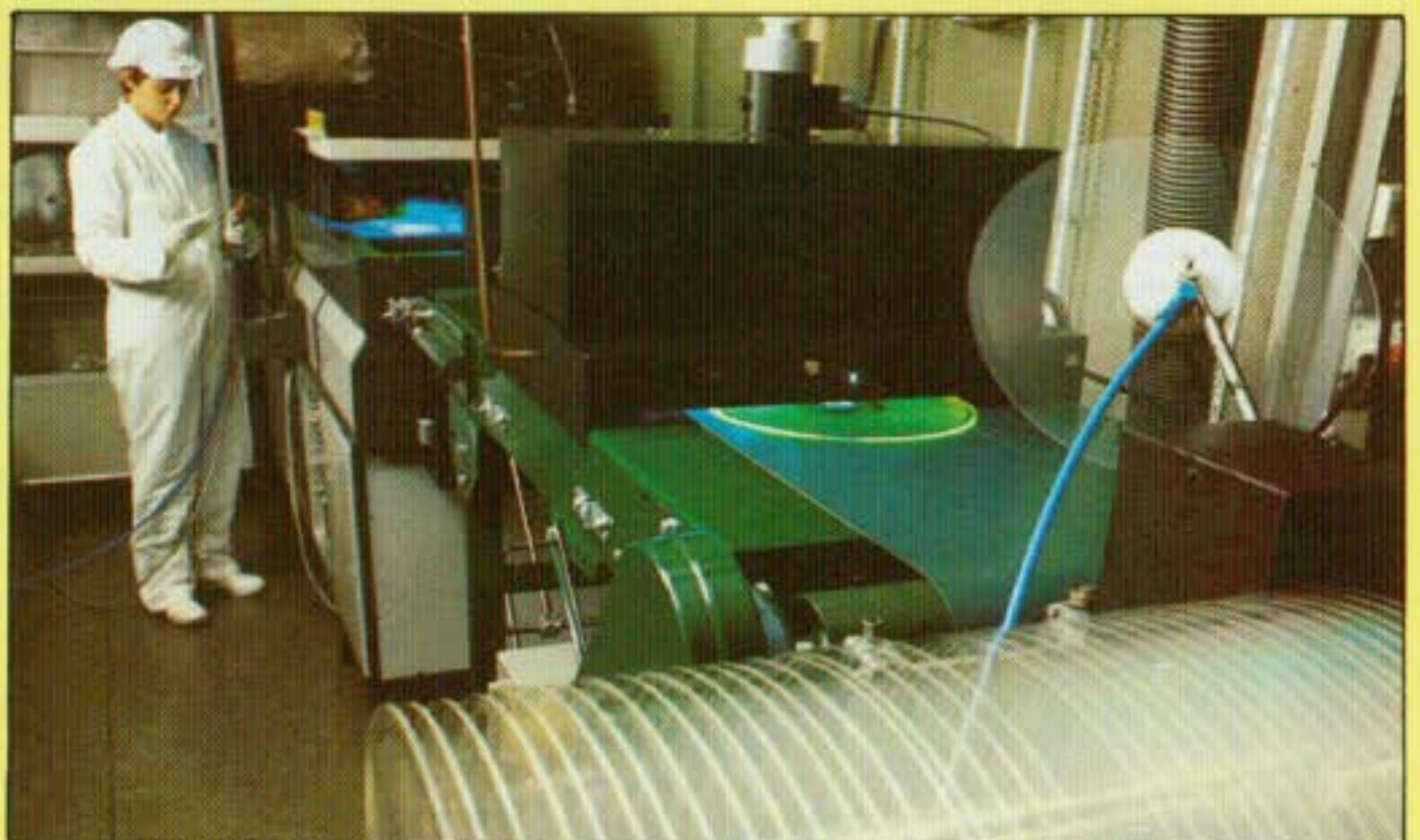
En cours de fabrication, les vidéo-disques LaserVision sont soumis à une exposition aux rayons ultra-violet.
