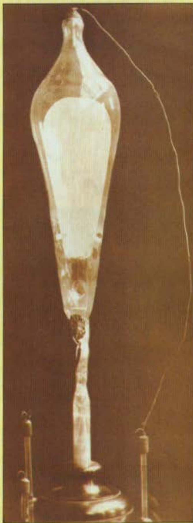
Tube de William Crooker pour l'étude des effets de décharges électriques.
