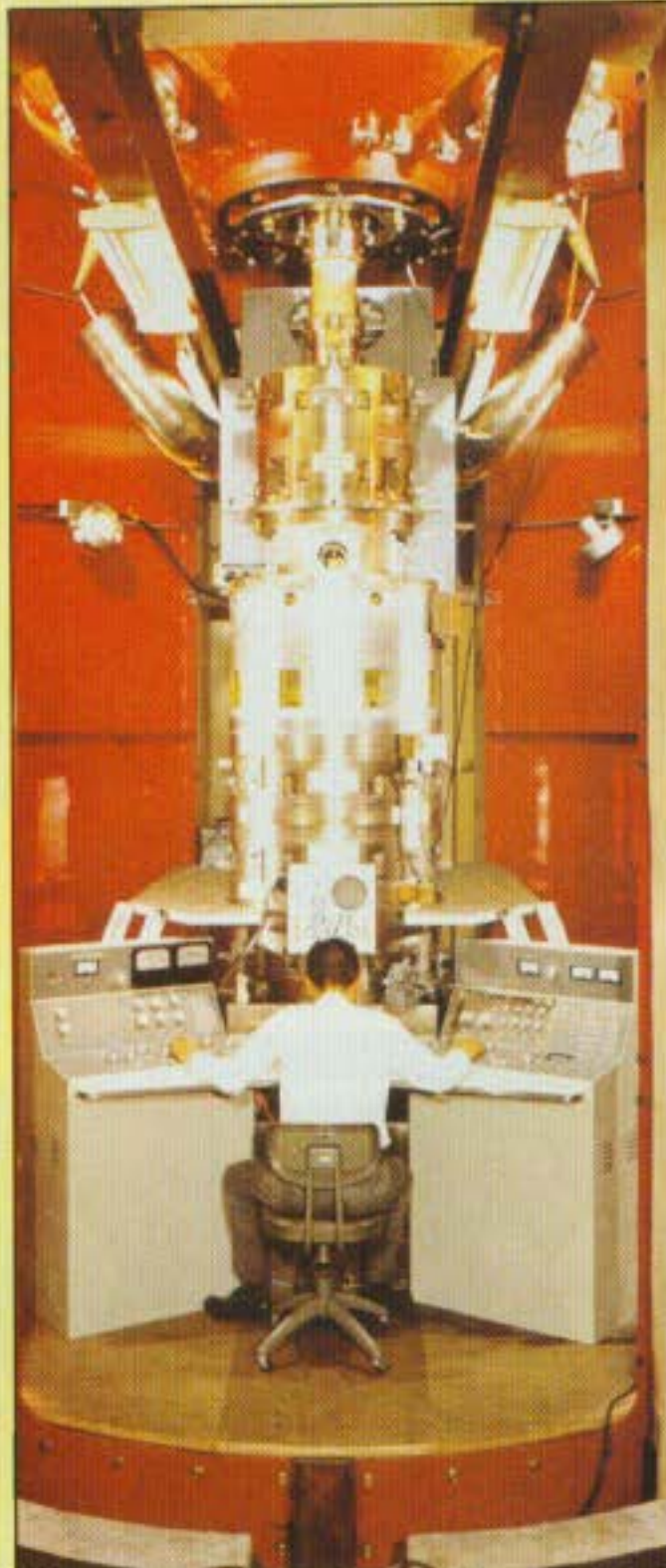
Microscope électronique récent (Hitachi 1970), dont l'origine remonte aux années 1900 (Birkeland, Bush).
