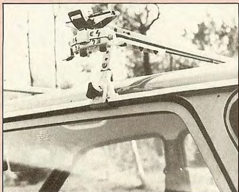
Boîtier supportant les trombones des deux antennes bandes 1. Ils contiennent les symétriseurs 200 ohms/75 ohms.
