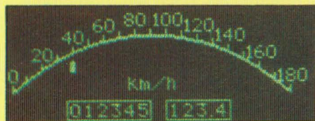
Affichage « VFD » par points pour automobile, couleur verte, très lumineux.
