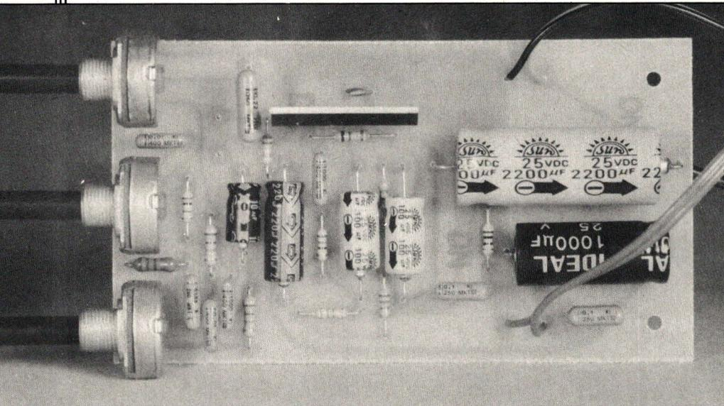
Nous vous proposons de réaliser ce petit amplificateur 5 W-4 ohms, de construction simple. Aucun réglage ni alimentation spéciale n'est nécessaire. Utilisable en appartement pour amplifier un lecteur de cassettes genre Walkman, en voiture comme amplificateur supplémentaire et pour bien d'autres usages suivant vos besoins.
