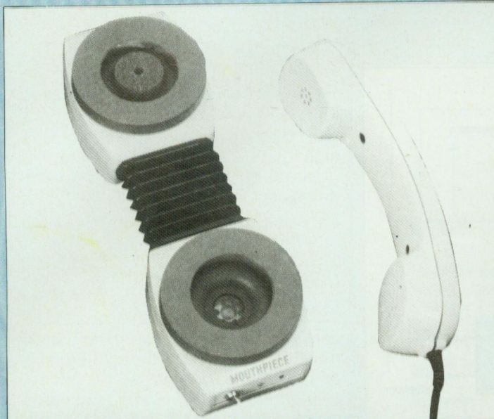
Fig. 7 : Interface acoustique pour Modem (Doc CDT)
