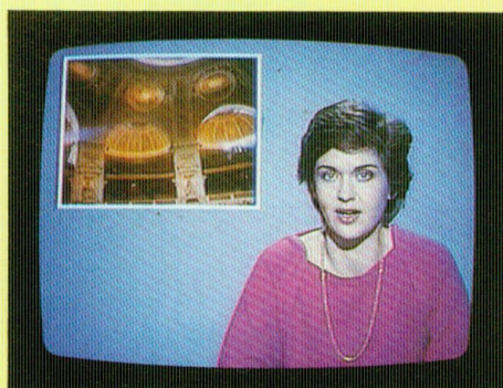
Fig. 5 : Obturateur focal, à déplacement vertical, réglé au 1/15 e s. Noter l'absence de tout rectangle foncé.
