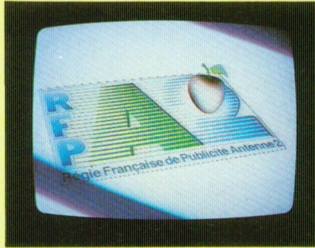
Fig. 2A : Obturateur focal, à déplacement horizontal, réglé au 1/60 e s. On distingue deux barres obliques.
