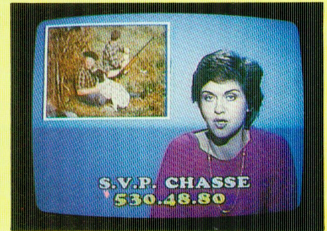
Fig. 3B : Obturateur focal, à déplacement vertical, réglé au 1/30 e s. Le rectangle, légèrement foncé, est localisé dans la moitié inférieure de la photographie.
