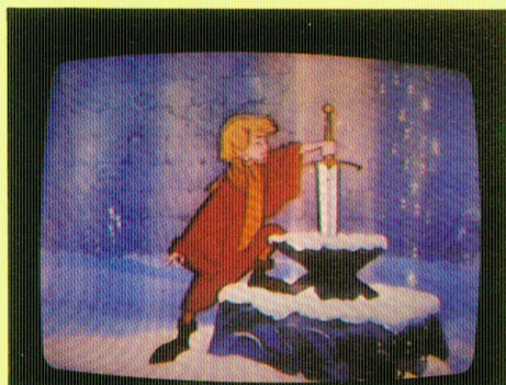
Fig. 4 : Obturateur focal, à déplacement horizontal, réglé au 1/15 e s. Aucune barre oblique n'est visible.
