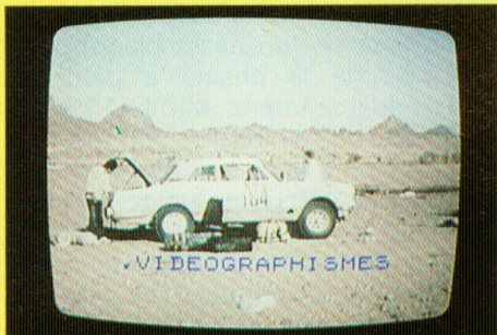
Titrage, sans bandeau, à défilement horizontal. La suppression du bandeau est obtenue en choisissant le noir («0») pour la couleur de ce dernier.
