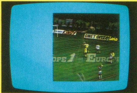
Fig. 5 : Effet «de rideau» correspondant à l'apparition progressive, de la droite vers la gauche, d'une image TV.
