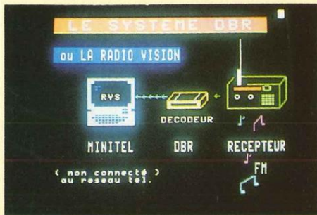
Fig. 5 : Schéma de branchement d'un décodeur DBR, côté utilisateur, dans le cadre d'une liaison Radiovision.
