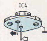
IC4 est à fixer sur un dissipateur.
