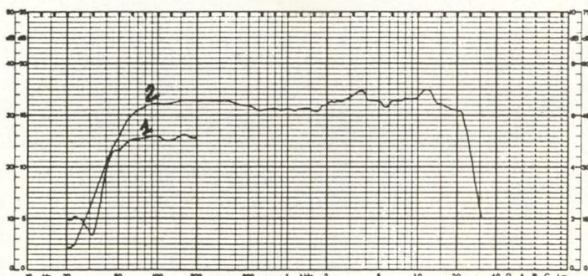
Courbe amplitude-fréquence dans l'axe du kit SEAS à proximité en 1 de l'évent, en 2 du haut-parleur grave de 20 à 200 Hz et à 1 mètre de 200 Hz à 20 kHz.
