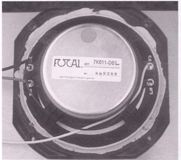
Le 7 K 011-DBL, un haut-parleur double bobine qui reproduit les graves et les médiums.
