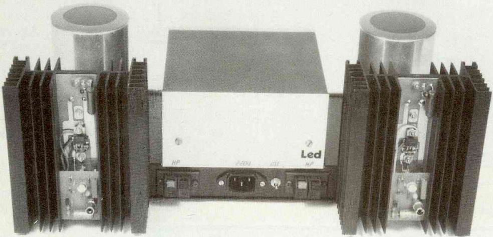
L'Amplificateur vu de l'arrière avec ses deux gros dissipateurs.
