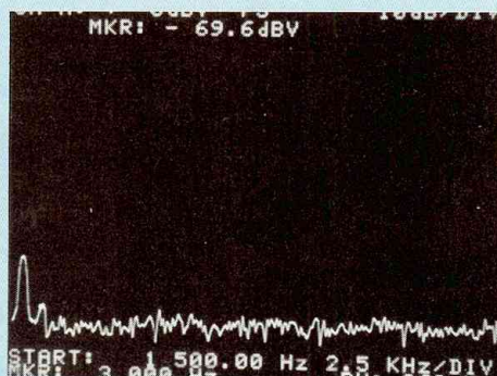
5. Spectre de distorsion à 1 kHz.
