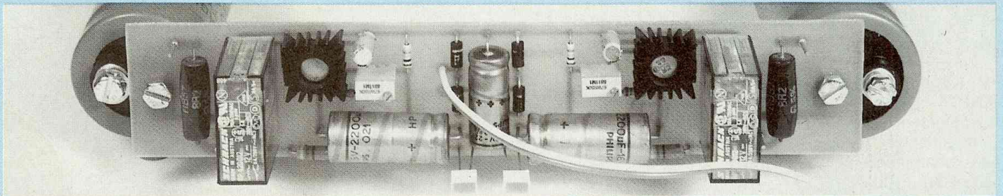
Le module de temporisation est maintenu en place dans le coffret ESM par les condensateurs de liaisons des amplificateurs (C6 - 4 700 \mu F/63 V).
