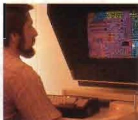
Conception de micro-circuits sur tablette graphique à l'aide d'un crayon optique.
