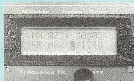
FREQ, quartz et fréquence. Fréquence "n"ormale de la cellule G. En haut, valeur du quartz de HF8.
