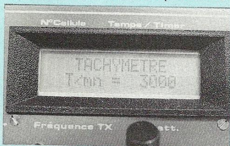
Ecran du tachymètre. Sonde tournée vers ampoule secteur donc 50 \times 60 = 3\,000 tr/mn.
