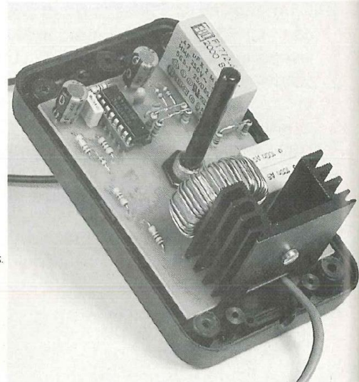
L'électronique est insérée dans un boîtier plastique muni d'une prise secteur.
