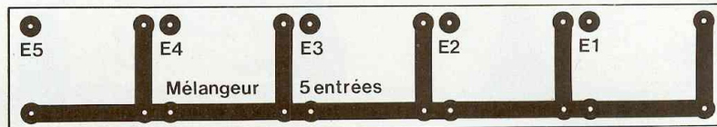
Fig. 5 : Circuit imprimé permettant le raccordement des fiches Jack.
