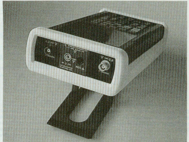
Photo II : Le sommet du scopemètre regroupe les diverses entrées, et les sorties de générateurs internes.
