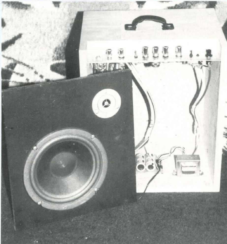
L'amplificateur terminé : c'est la face avant qui est amovible, fixée par le fond et les deux côtés du coffret. La finition est en placage frêne.
