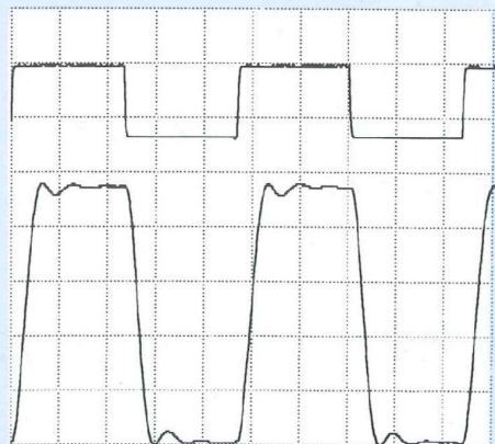
D - Signal carré à 10 kHz. Temps de montée de 7 \mu s
