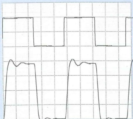
4 : Signal carré à 10 kHz à une puissance de 50 Weff. Le temps de montée est de 4,5 μs. La cellule de rétroaction est ici de 2,2 kΩ/1 nF.
