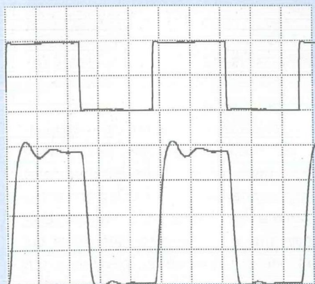
4 : Signal carré à 10 kHz à une puissance de 50 Weff. Le temps de montée est de 4,5 \mu s. La cellule de rétroaction est ici de 2,2 k \Omega /1 nF.
