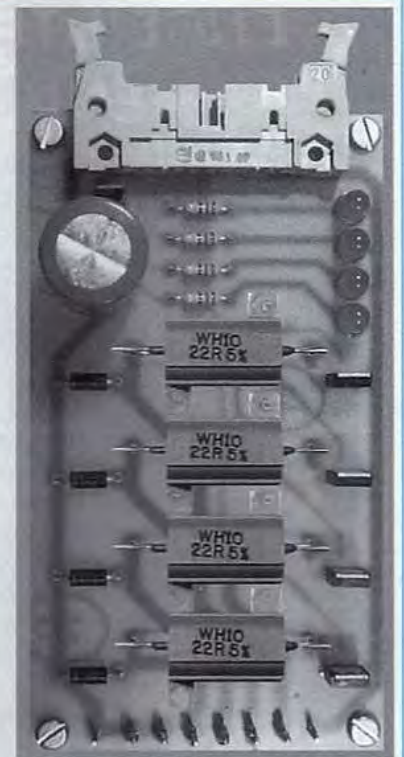
Figure 13 : utilisation d'un dissipateur externe
