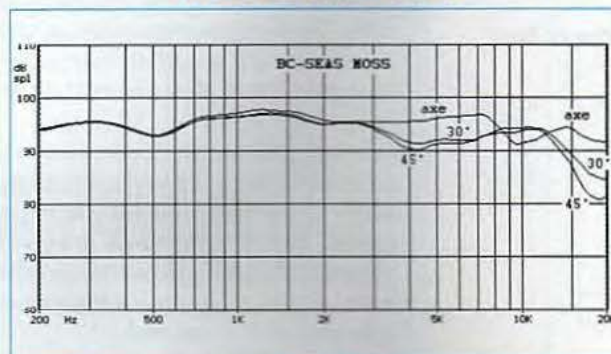
Courbe de réponse, de 200 Hz à 20 kHz dans l'axe, à 30°, à 45° dans un plan horizontal
