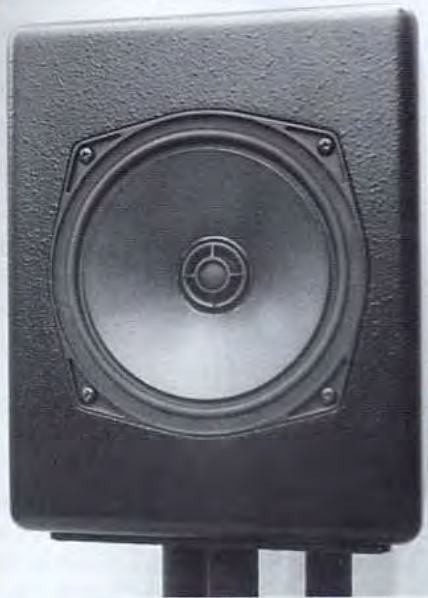
Photo 1 : Caisson et SP1460
