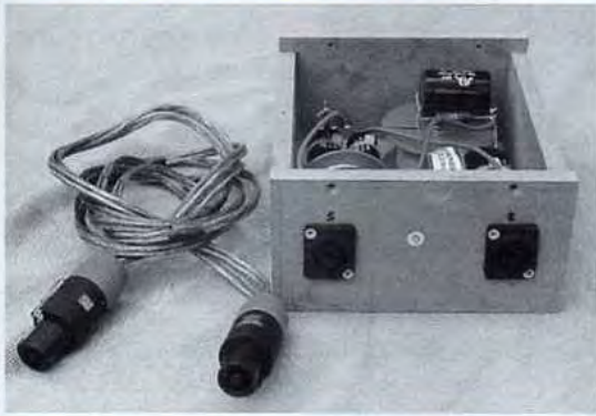
Photo 7 : le filtre avec le câble d'interconnexions
