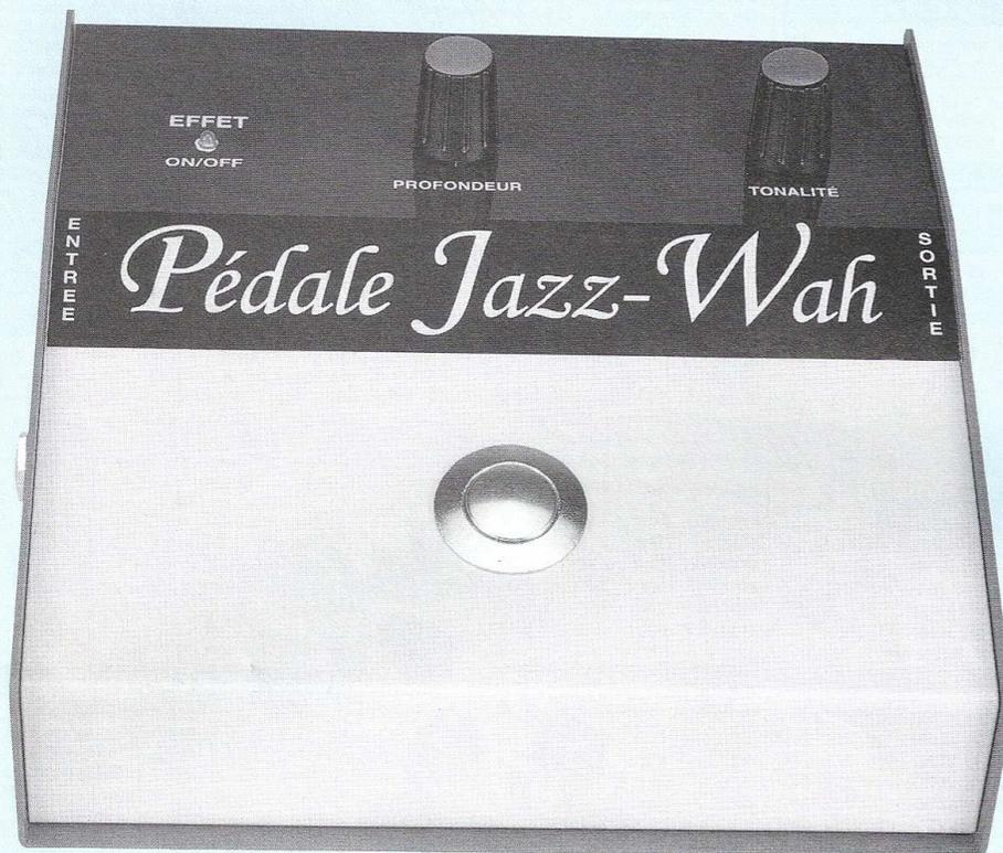
L'effet «wah-wah», très utilisé par les guitaristes, est réalisé à partir d'un filtre passe-bande dont la fréquence centrale dépend de la position d'une pédale au pied. Le musicien commande manuellement le filtre en fonction de l'effet recherché. Nous vous proposons ici une variante qui vous évitera le souci d'une réalisation mécanique plus délicate à entreprendre.
