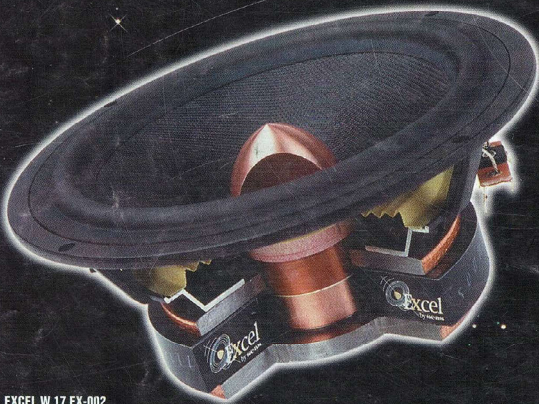
EXCEL W 17 EX-002 Woofer-médium de 17 cm Rendement 90 dB Bande passante de 40 Hz à 2,5 kHz
