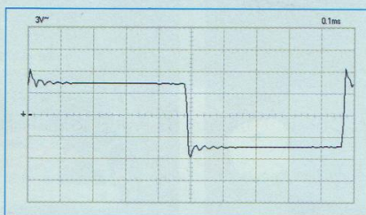
Signal carré à 1 kHz (8 Ω + 1 μF)
