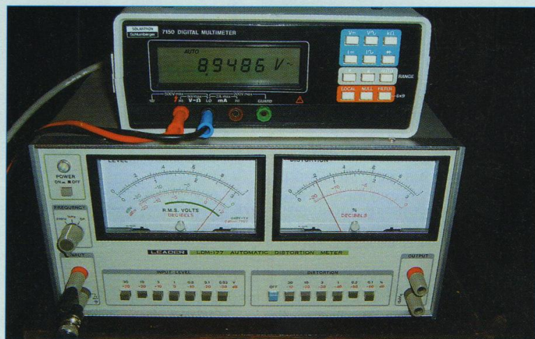
Distorsion à 1 kHz et à 10 W : 0,06 %
