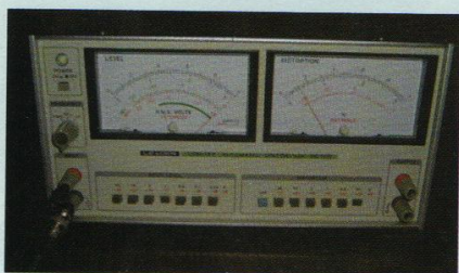
Taux de distorsion pour un signal de sortie de 1 volt efficace (< 0,02 %)
