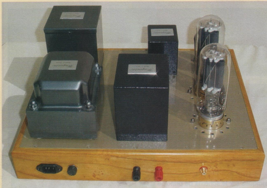
Vue de l'arrière du Push-pull 845 achevé avec ses prises de raccordements. A vous le plaisir de l'écoute de cette extraordinaire triode !
