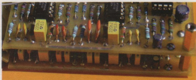
Figure 12a : Condensateurs au pas de 5,08 mm
