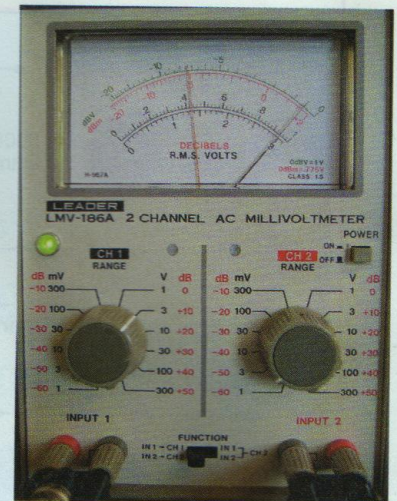
Mesure à 100 Hz Canal 1 : 3 Vac Canal 2 : 1,4 mVac
