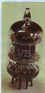
Photo A L'étage déphaseur câblé. Il est équipé des tubes 5725
