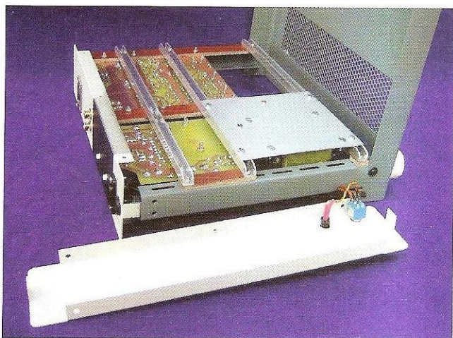
Photo 0 : Châssis ouvert autorisant une excellente accessibilité aux différents modules pour un éventuel dépannage
