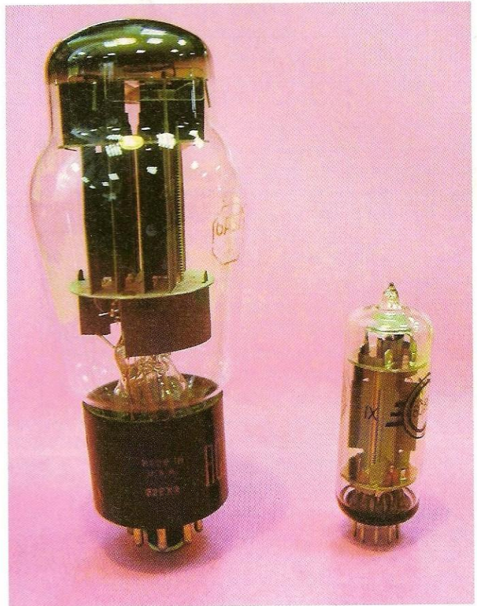
Photo 2 : Malgré sa taille ridicule en comparaison des 6AS7G, la 6C19 est capable de faire circuler un courant de l'ordre de 140 mA
