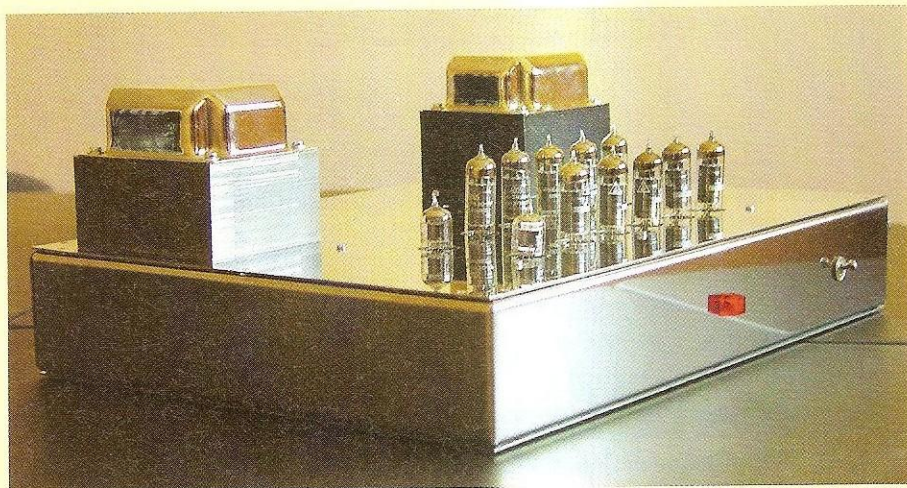
Photo D : L'amplificateur de 50 W monté sur un châssis Tub'Ox
