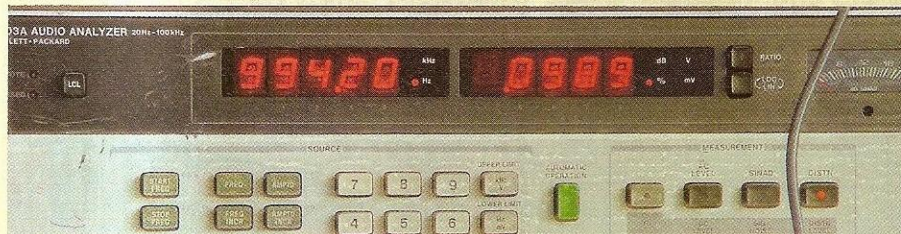
Taux de distorsion de 0,0989 % mesuré à la puissance de 1,3 W (fréquence de 1 kHz)
