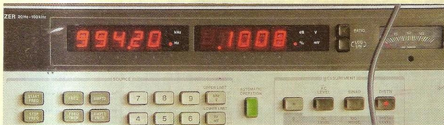
Taux de distorsion de 0,1008 % mesuré à la puissance de 2 W (fréquence de 1 kHz)
