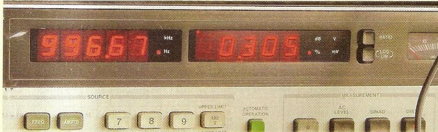
Taux de distorsion de 0,305 % mesuré à la puissance de 5,6 W (fréquence de 1 kHz)
