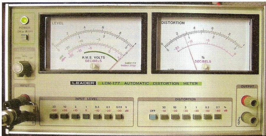
Photo L : Mesures DHT: 0,026 % à 1 Vac 1 kHz
