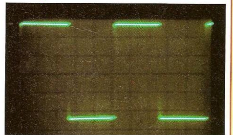
Signal carré à 10 kHz de 50 V crête
