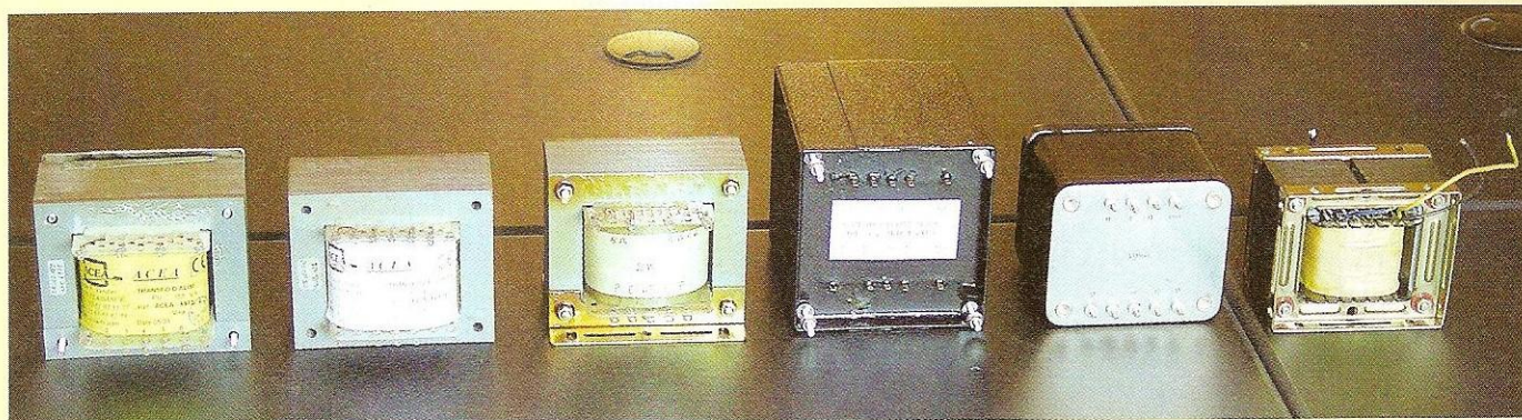
Photo F : L'amplificateur de 50 W a été testé et écouté avec six transformateurs de sortie différents
