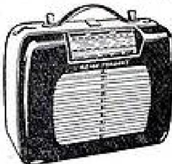
Récepteur super-hétérodyne OC - PO - GO - lampes miniatures et redresseur Selenium. Cadre incorporé PO - GO et prise antenne OC - PO - GO. Alimentation secteur alternatif 110-120-220 et continu 220 V. Piles 90 et 9 V. Coffret élégant en plastique avec cadran sur les 2 faces de l'appareil. Puissant, sensible, musical. Poids sans piles : 3,8 kg. Dimensions : 328 x 250 x 130. Livré avec housse de protection.
