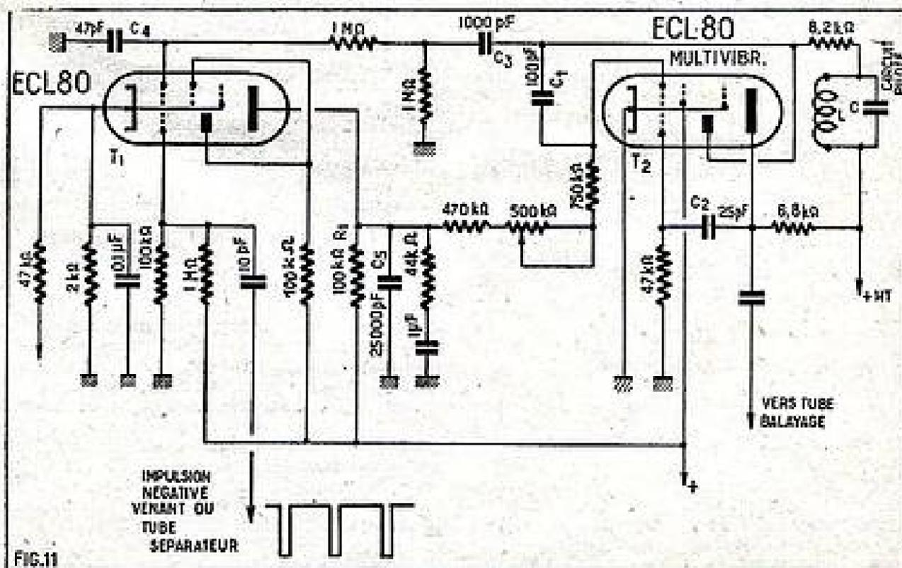
FIG. 11. — Schéma complet d'un comparateur à coïncidence.
