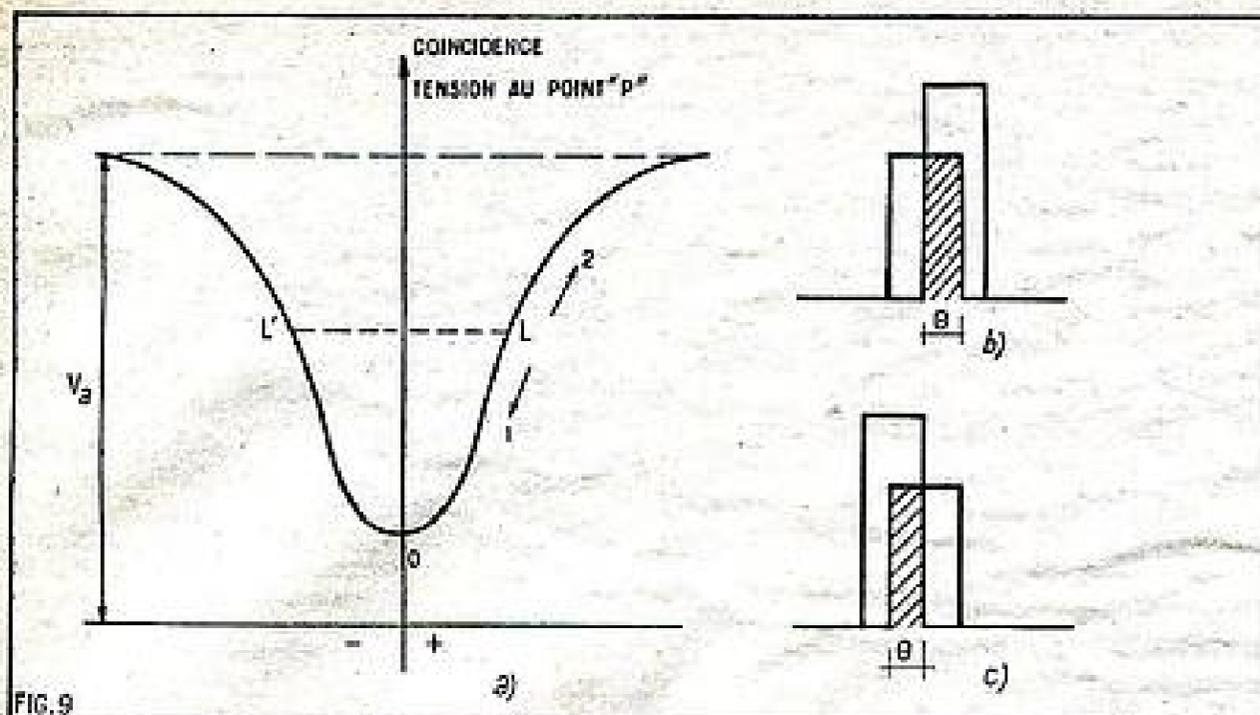
FIG. 9. — Tension sur l'anode en fonction du degré de coïncidence. Les points L et L' correspondent à des positions symétriques des deux impulsions.
