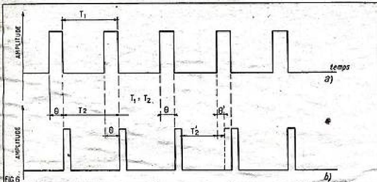
FIG. 6. — Deux tensions de même fréquence se présentent toujours avec la même position de phase.
