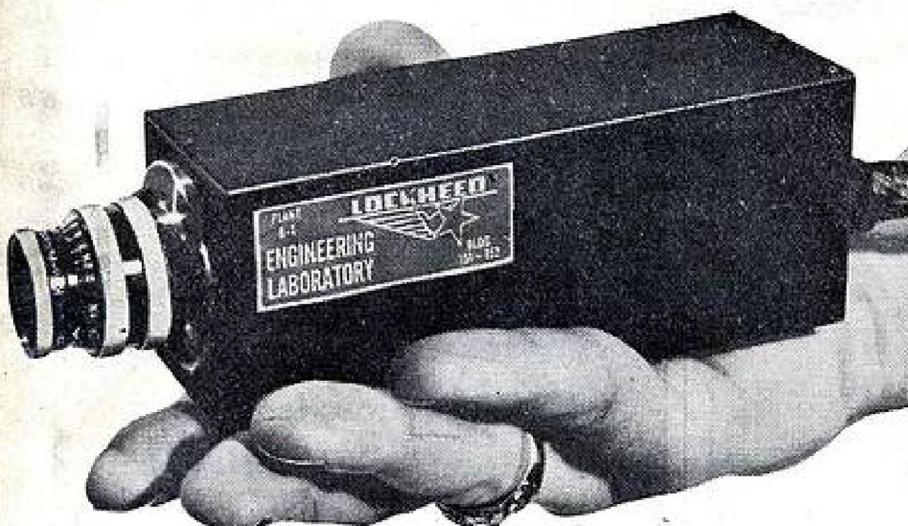
*La minuscule caméra de télévision, qui tient dans le creux de la main, mise au point par les ingénieurs électroniciens de la Lockheed Aircraft Corporation.*
