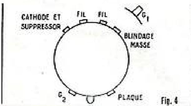
(alimentation à vibreur ou convertisseur rotatif ?) Le + 200 V arrivait à la prise 4 et le - 200 V à la prise 5. Cette dernière étant reliée à la masse par une résistance de 100  $\Omega$ , 4 W, se trouve à un potentiel négatif assurant la polarisation de la lampe finale. La broche 6 de la prise multiple constitue uniquement une tige-guide.
