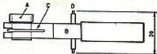
Le circuit magnétique est composé d'un cylindre de ferrodure à aimant radial A, d'un entrefer entre deux pièces polaires (protégé d'une gaine plastique) B, d'un ressort annulaire et d'une pièce d'écartement isolée D.
