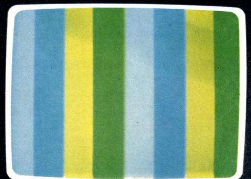
▲ Mire obtenue avec rouge sur sortie bleu bleu sur sortie vert vert à niveau constant 1
