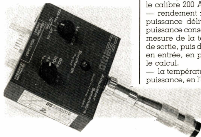
Adaptateur sonométrique, équipé de son microphone électret.
