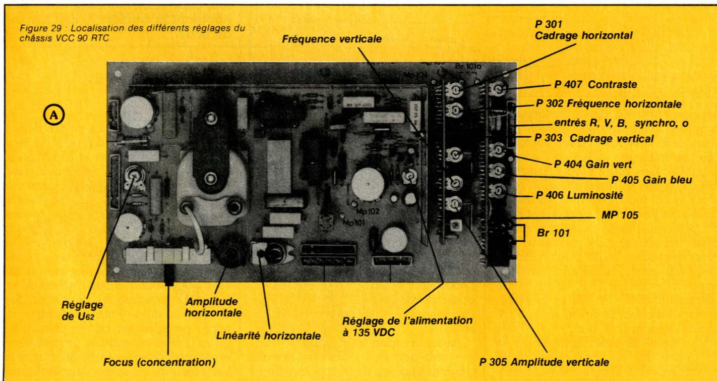
Figure 29 Localisation des différents réglages du châssis VCC 90 RTC
