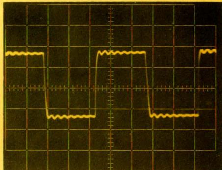
Réponse en rectangulaires à 10 kHz. La tendance aux entrées en oscillation montre la difficulté d'utilisation des amplis Hi-Fi en circuits intégrés.
