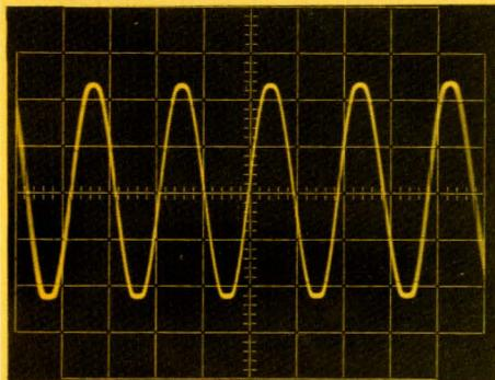
L'écrêtage intervient de façon symétrique sur les pointes positives et négatives. Fréquence : 1 kHz. Sensibilité verticale : 5 V/division.
