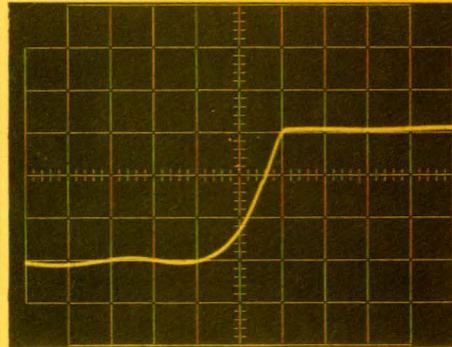
Le temps de montée s'établit aux alentours de 3,5  $\mu\text{s}$ , ce qui est tout à fait convenable. Vitesse de balayage : 2  $\mu\text{s}$ /division.
