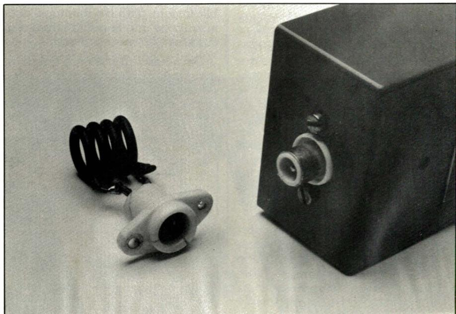
res de fil de section 1,5 mm<sup>2</sup> (non jointives), espacement 1,5 mm entre spires, Ø du bobinage : 11 mm, L bobinage : 18 mm,
