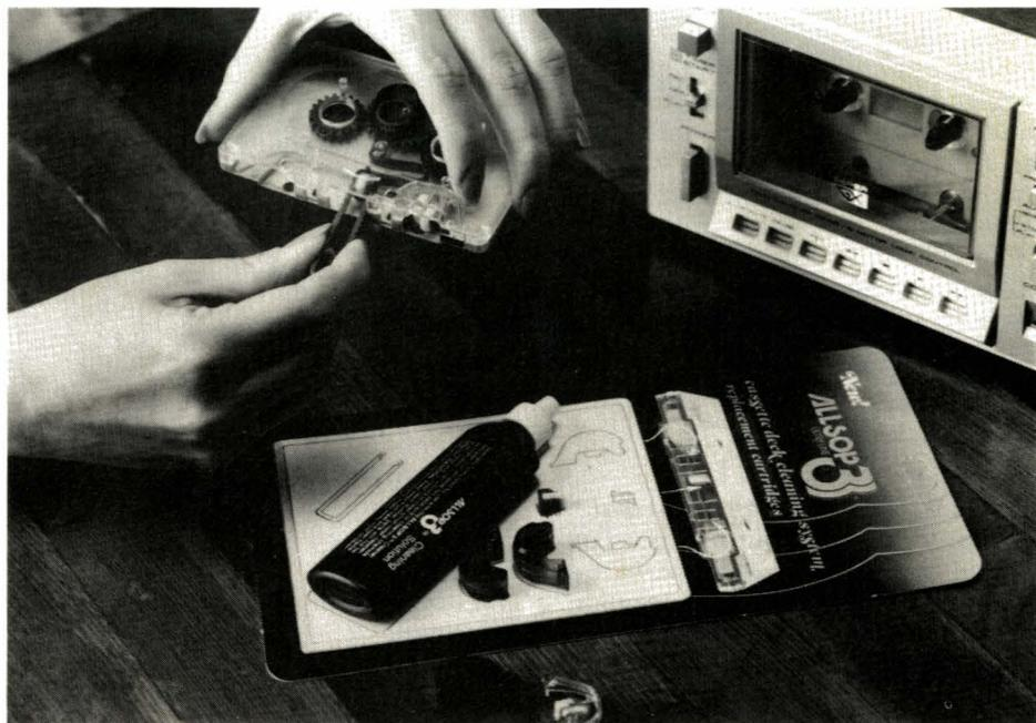
bielle-manivelle, transformant ici un mouvement circulaire — celui du moteur du magnétophone — en un mouvement alternatif, celui d'un balai en feutre appliqué contre la tête d'enregistrement lecture. Par ailleurs, lors de leur mouvement de rotation, cabestan et galet presseur frottent constamment contre le tampon de feutre, qui les nettoie donc en permanence.
