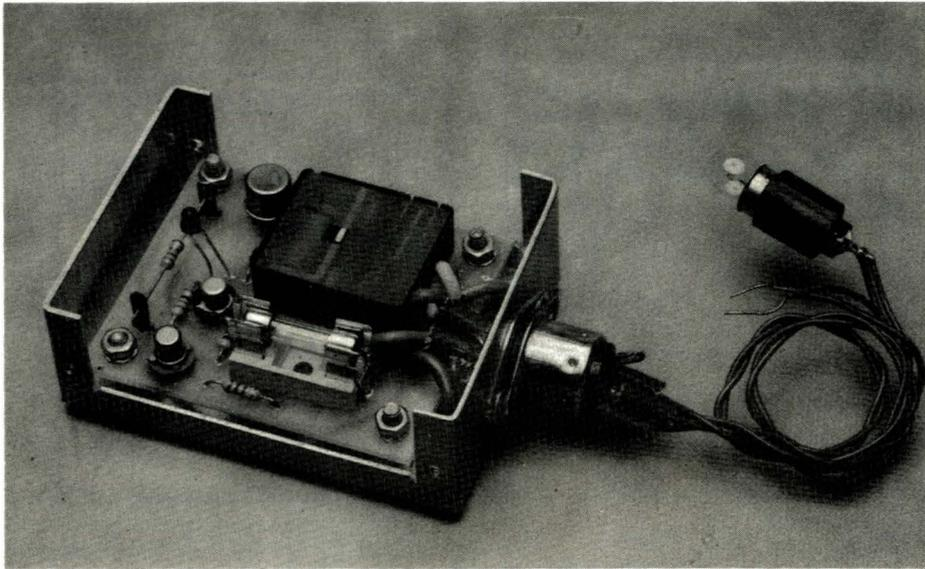
devant du coffret pour la mise en place de l'embase DIN mâle 270°. Cette dernière sera fixée, soit à l'aide de vis et écrous, soit par deux petits rivets « POP ».
