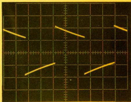
Réponse en signaux rectangulaires à 100 Hz. La pente au toit correspond aux limitations de la bande passante vers les basses fréquences. Sensibilité verticale : 5 V/division.
