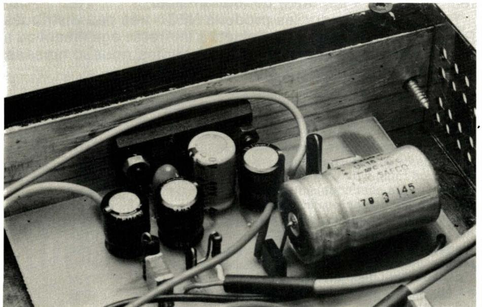
raisons d'approvisionnement, on prendra  $47 \Omega$  pour  $R_3$  et  $0,22 \Omega$  pour  $R_4$ , ce qui aura pour conséquence d'obtenir un niveau d'entrée légèrement supérieur à celui admissible par le booster mais que l'on pourra facilement compenser par le réglage de volume de l'ampli.
