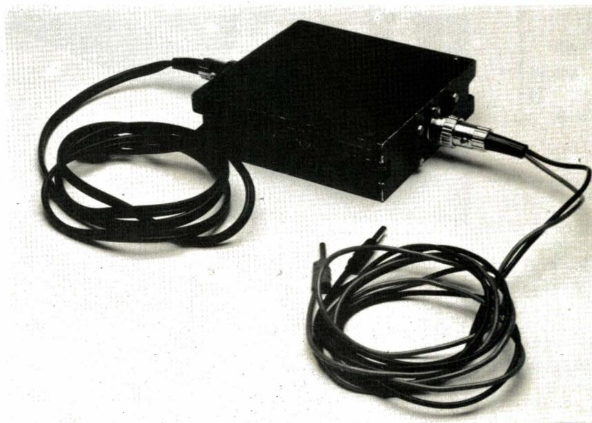
L'amplificateur que nous vous proposons peut délivrer  $2 \times 23 \text{ W}$  lorsqu'il est alimenté à partir d'une batterie de voiture, soit environ  $14,5 \text{ V}$  sous une impédance de charge qui ne devra jamais être inférieure à  $4 \Omega$ .
