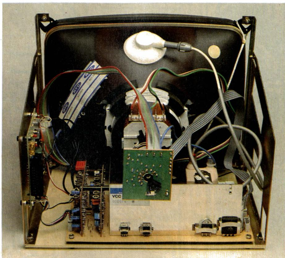
Ce second article concernant la description du moniteur couleur RTC VCC 90 donne les détails nécessaires à l'assemblage correct du kit. A ce propos, il nous semble essentiel de préciser que vu l'importance de la réalisation et de son coût, la manipulation délicate du tube couleur, les dangers existant au niveau de la mise au point relatifs à la présence de tensions de 7 à 25 kV à certains points de montage; il est fortement conseillé de posséder une bonne pratique des montages complexes.
