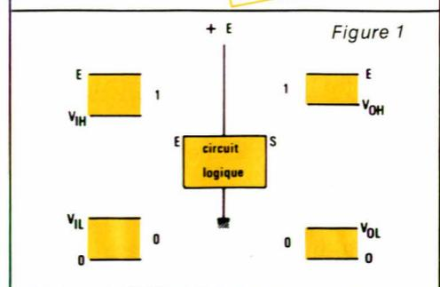
•  $V_{IH}$  (I = input, H = high), est la tension minimale que doit recevoir une entrée, pour se trouver sûrement au niveau logique 1. Là encore, toute tension comprise entre  $V_{IH}$  et  $+E$  est perçue comme un niveau 1.
