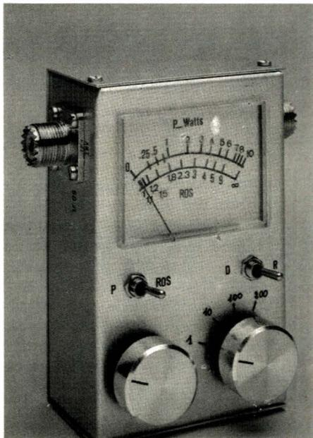
sa graduation doit permettre de mesurer d'une part une puissance et d'autre part un ROS. La graduation en puissance va de 0 à 10 W. Le tableau ci-dessous donne la valeur de la puissance et du ROS en fonction de la valeur du courant exprimé en
