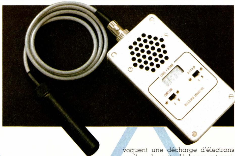
et une électrode centrale qui est l'anode. Les radiations provoquent un déplacement d'ions dans la chambre, elle est alors traversée par un très faible courant, celui-ci est ensuite amplifié par un circuit à très haute impédance d'entrée. Un galvanomètre placé en sortie permet de lire le niveau de radiations.
