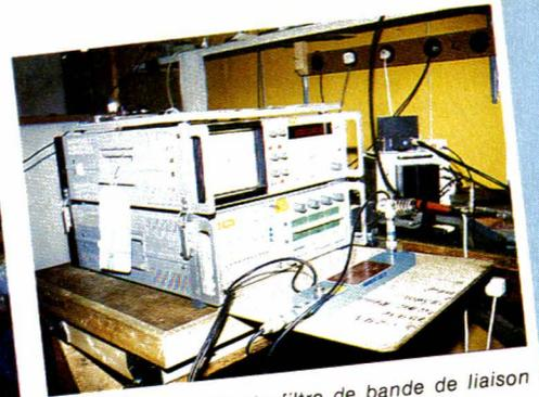
Mesure et contrôle du filtre de bande de liaison driver amplificateurs de puissance.
